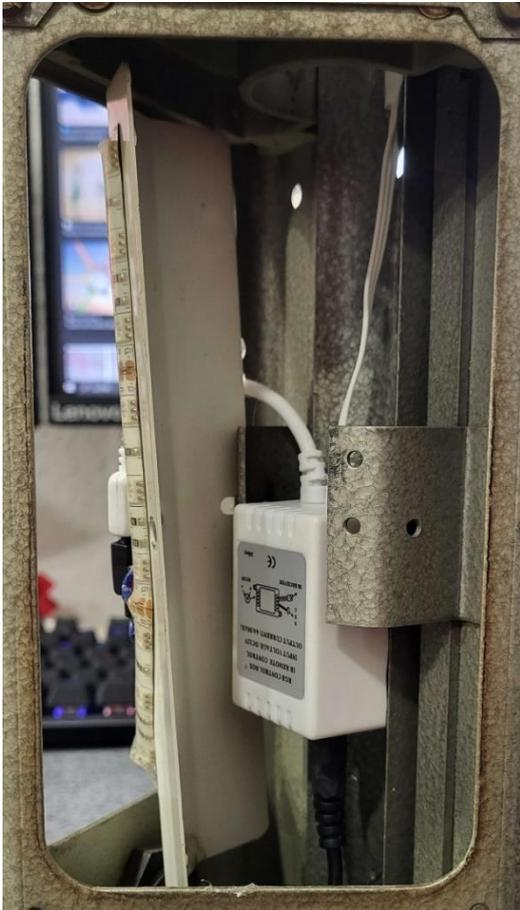
Als Nächstes stecken wir das Stromkabel in die Kiste. Ich habe es durch eines der Schraub-öffnungen geführt, dafür musste ich diese mittels des 10mm-Bohrers aufbohren und den 12V-Stecker durchführen. Es empfiehlt sich, einen Knoten in das Kabel zu machen, damit es nicht durch die Öffnung zurückgeht und versehentlich ausgestöpselt wird. Auch dieser Knoten wird mit Kleber fixiert!
