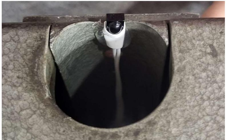
Zum besseren Halt wird das Abdeckblech erstmal gereinigt, dann können wir die LED-Streifen auf den seitlich abgeschrägten Seiten fixieren. Das Kabel von der Steuerbox (Weiß) wird mit dem LED-Streifen zusammengesteckt und mit Heißkleber fixiert. Achtet drauf, dass die Kabel keine LEDs überdecken!
